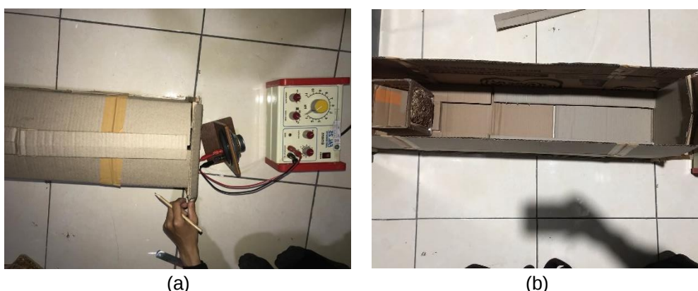
Gambar 1. Desain alat untuk mengukur efektivitas reduksi kebisingan material akustik dari kulit singkong. (a) bagian tertutup, dan (b) bagian terbuka.
